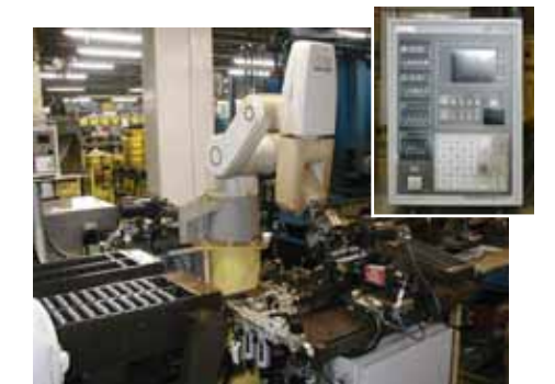
小型ロボットと豊田工機製の接触式計測機をあわせたオンライン計測システム
