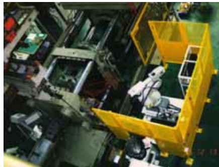
630t横型成形機への金具インサートシステム
