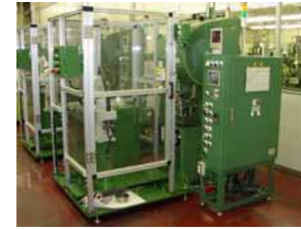
30KNプレスと水平多関節ロボットの組み合わせによるワーク(焼結部品)の移載システム
