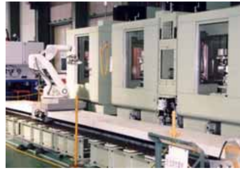
素材供給ローダと走行ロボット・横形マシンングセンタの組み合わせによるアルミ部品加工ライン
