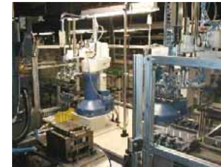
縦型成形機とロボット2台の組み合わせによる、サブアッシー品インサート、成形品取出しシステム
