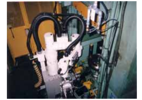
350tプレスと中型水平多関節ロボットを組み合わせた軸物冷間鍛造プレスの自動化
