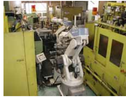
中型ロボットとトランスファマシン・マシンングセンタの組み合わせによる家電部品加工ライン
